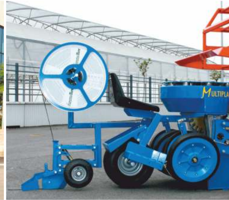
STENDI MANICHETTA CON VOMERE INTERRA MANICHETTA | WATER PIPE STRETCHING TOOL WITH PLOUGHSHARE TO EARTH WATER PIPE UP | SYSTÈME POUR ÉTENDRE LE TUYAU DE L'EAU AVEC SOC POUR ENTERRER LE TUYAU DE L'EAU | EXTENSOR MANGUERA CON REJA ENTERRA MANGUERA SCHLAUCHLEGEGERÄT MIT SCHLAUCHUNTERPFLÜGSCHAR
